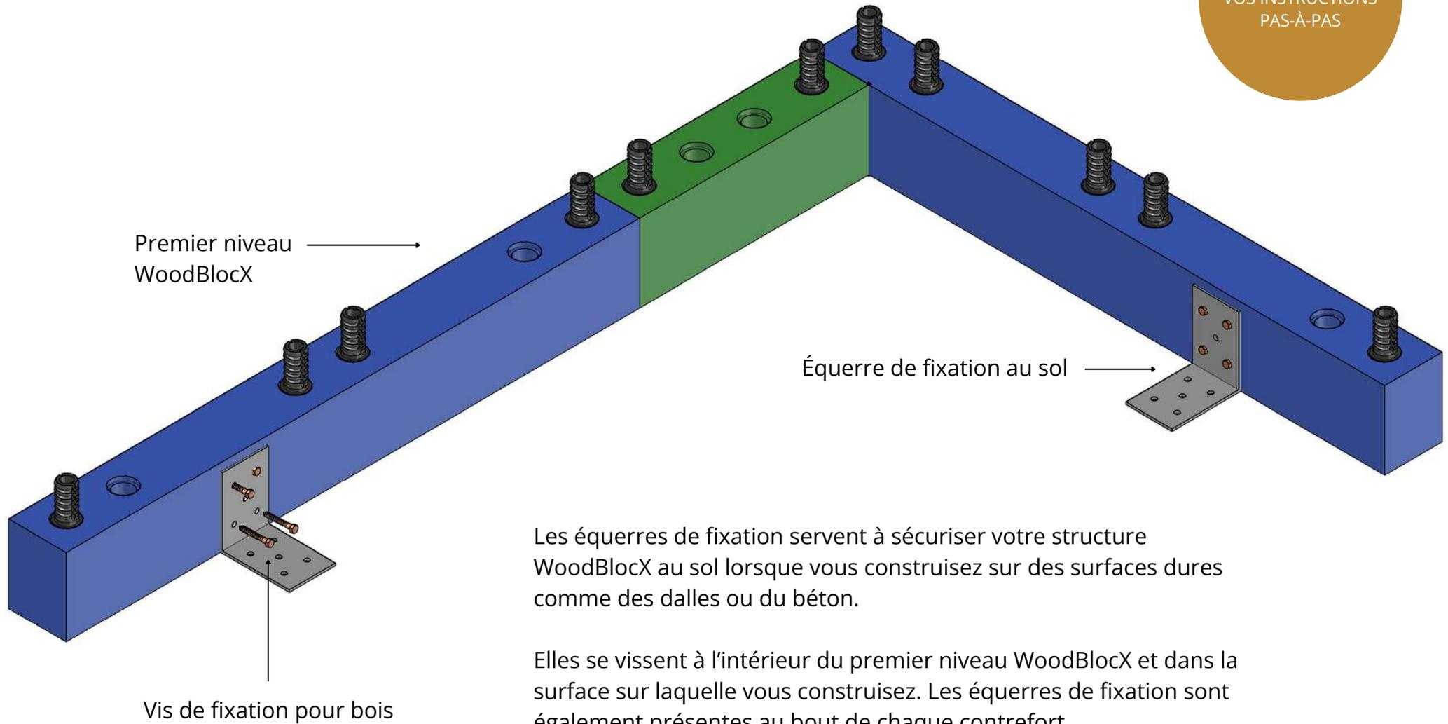
Les équerres de fixation servent à sécuriser votre structure WoodBlocX au sol lorsque vous construisez sur des surfaces dures comme des dalles ou du béton.
